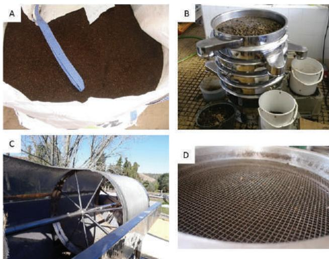
Figura 13 - Substrato convertido em fertilizante orgânico e processo de separação. A - Substrato convertido/fertilizante orgânico, B - peneira vibratória semi-industrial, C - Peneira de tambor rotativo, D - pormenor de peneira vibratória. (imagens EntoGreen)
